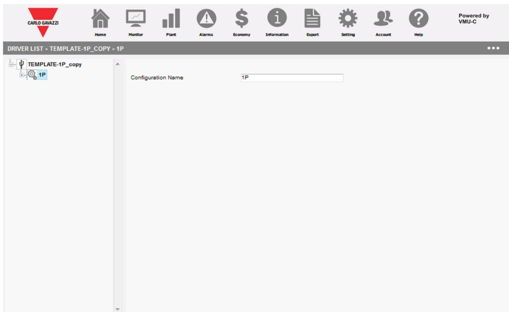
Les configurations représentent des modes de fonctionnement différents au sein du même analyseur. Certains analyseurs peuvent avoir des modes de fonctionnement différents, leur permettant de travailler dans des systèmes à 3 ou 1 phase. Pour cette raison, le même driver peut contenir des configurations différentes qui se réfèrent à différents modes de fonctionnement.
