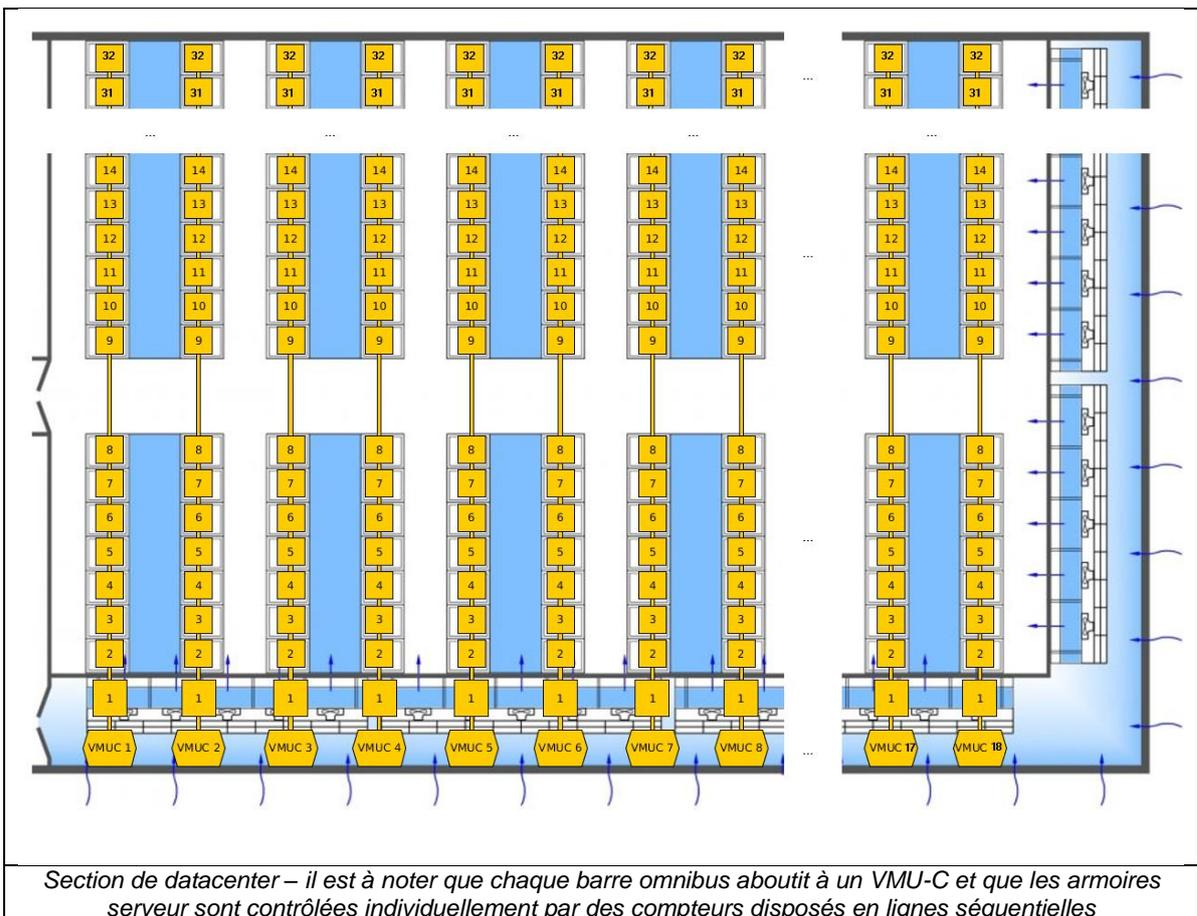
Dans les applications de ce type il est vital de réduire les délais d'installation du système, en tenant compte du fait qu'il s'agit d'environnements où l'utilisation des barres omnibus impose des déplacements horizontaux et verticaux, qui requièrent, de par leur nature, de long délais.
