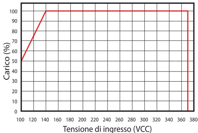
\* I componenti dell'alimentatore possono deteriorarsi o essere danneggiati quando l'alimentatore viene continuamente utilizzato all'interno (o all'esterno) della regione ombreggiata, fare riferimento al grafico.
