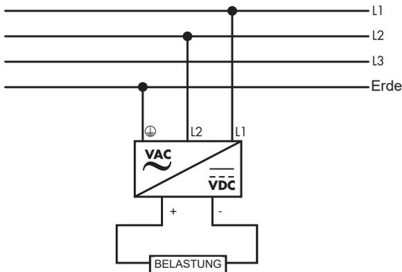
Jede der beiden Drähte kann beliebig angeschlossen werden: (L1/L2), (L2/L3), (L1/L3)
