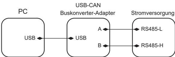
Verbinden Sie die RS485-L und RS485-H des Signalterminals mit dem USB-Schnittstellenmodul. Wenn die Kommunikation mit dem Host-Computer eingeschaltet ist, öffnen Sie die Software „Carlo Gavazzi ModbusMonitor V1.03“. Wie es im folgenden Bild mit Benutzeroberfläche der Software dargestellt ist, ist es erforderlich, den richtigen seriellen Port und die richtige Baudrate auszuwählen, um so die von der Software verfügbaren Informationen zu überprüfen. Klicken Sie auf „Connect“ und „Read“.
